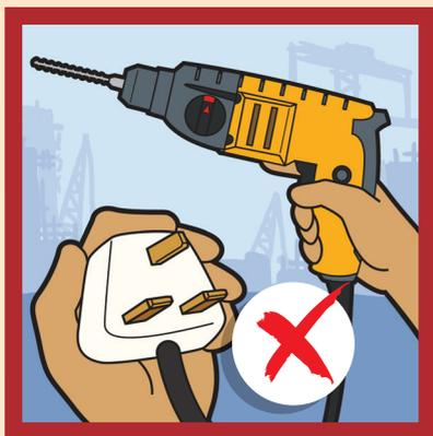
切勿将家庭用插头装在手持式电器，因家庭用插头的设计构造并不适用于施工现场
