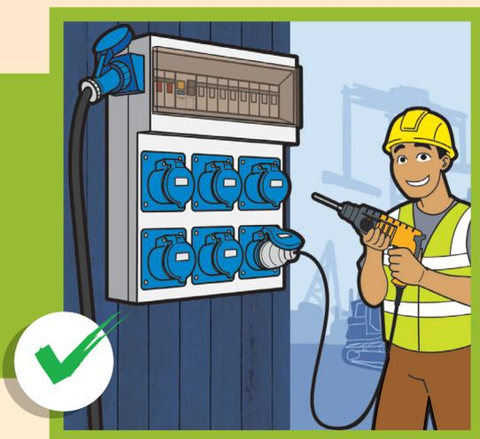
切勿将较长的电缆摆放于地上，使用适当的支架撑起电缆以防止损坏
