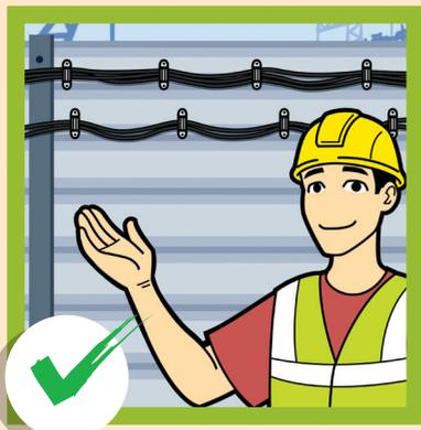
电缆应有适当的支撑与固定
